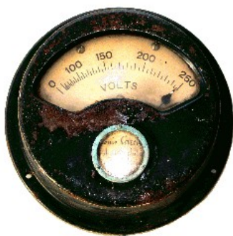
Restes du voltmètre brûlé
