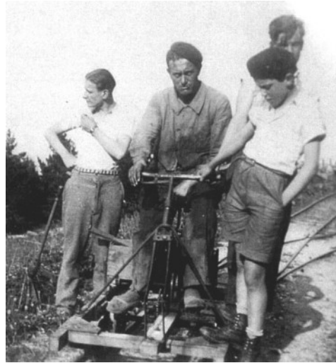
Bicyclette sur rail construite en 1942 par Clément DONETTA, chef de chantier, pour se rendre de la carrière du CAILLAU au Domaine de COVAZET
